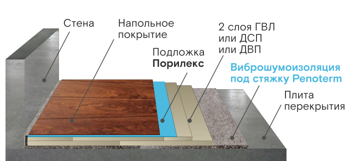
Конструкция сухого плавающего пола
